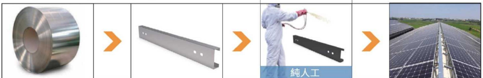
品質好：先進連續式烤漆、並輔以AI視覺辨識切口修補烤漆系統，品質控制有保障。
